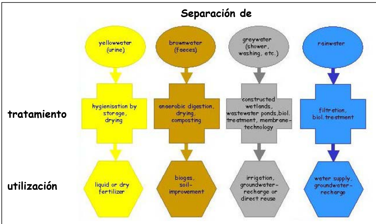
Figura 3: Ejemplos de los sistemas de instalaciones ecosan 2
