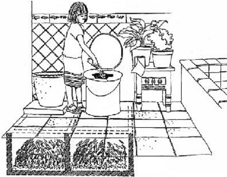
Hình 3.5 Biến thể của nhà tiêu hai ngăn Việt Nam ở Mêhicô, được xây dựng trong phòng tắm trong một ngôi nhà tiêu chuẩn cao hiện đại ở thành phố Cuernavaca. Nhà tiêu có bộ tiêu xôm di chuyển được với chỗ thoát nước tiểu. Hầm cầu phía dưới nhà tắm có thể lấy phân được từ bên ngoài nhà.
