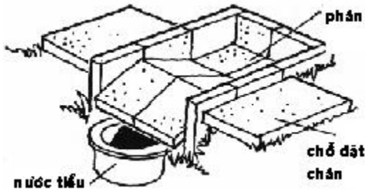
Hình 4.5 Một nhà tiêu truyền thống tách nước tiểu ở Trung Quốc. Nước tiểu chứa trong hủ dùng để làm phân cho rau. (Phân được xúc hàng ngày để đưa vào nơi phân hủy).
